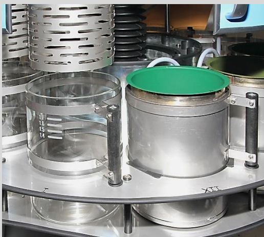
Przestrzeń robocza aparatu Widać teflonowane wnętrze naczyń ciepłarki
