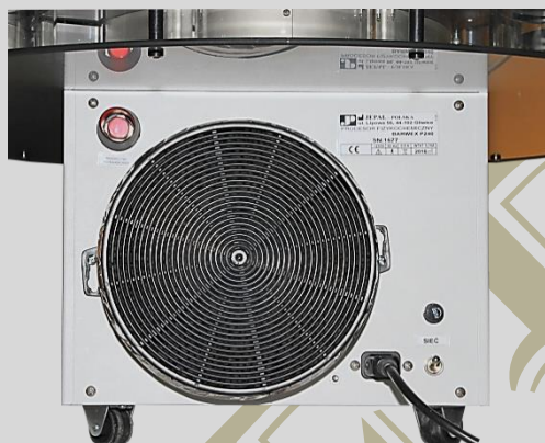
Tył aparatu : przycisk serwisowy (z lewej górnej strony) , wyłącznik i kabel sieciowy, tabliczka znamionowa . Pokazano opcje wyciągu z filtrem węglowym lub z króćcem wylotowym , z nasuniętym węzłem odciągowym . Widoczne rolki do obrotu aparatu wokół jego osi głównej
